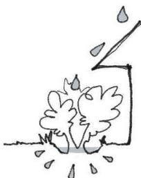
Le processus de réten-tion-infiltration se caractérise par la création dans le sol d'un espace de rétention perméable à l'eau pluviale, tel qu'un jardin de pluie, une noue, etc. Cet aménagement permet à l'eau d'être retenue ponctuellement avant son infiltration dans le sol puis la nappe phréatique.
