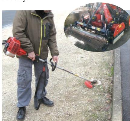
Reciprocateur et desherbeuse mécanique
